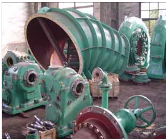
(d) Local production of Chinese SHP turbine equipment.
